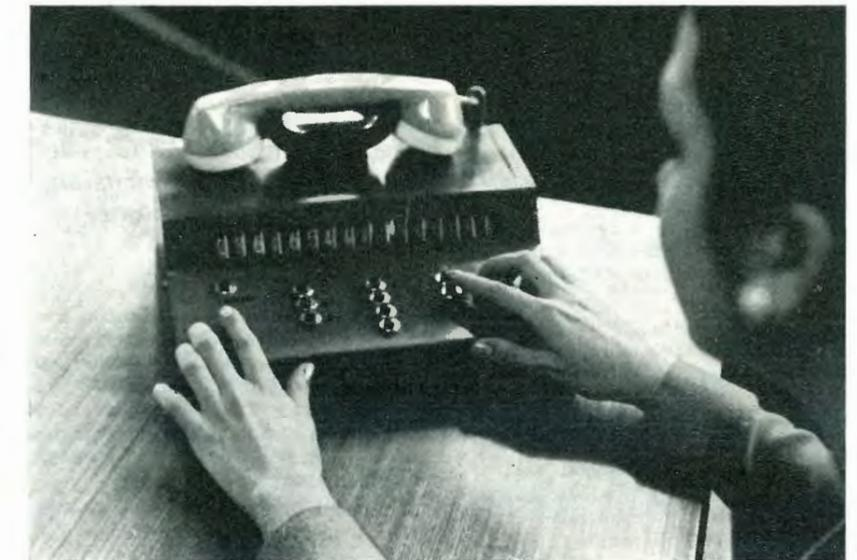
Prototipo di un telefono elettronico realizzato presso i laboratori della S.G.S. di Agrate Brianza.
